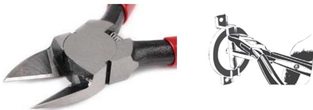
Particolarmente indicati per il taglio di pezzi o matorozze il cui accesso dovesse risultare difficile.
