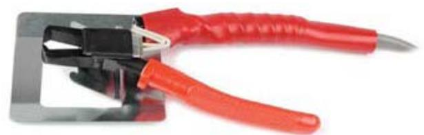
Alcuni materiali, per esempi PC, PMMA, etc, soffrono lo stress del taglio meccanico esercitato nel taglio della matarozza mostrando striature lattiginose. I tronchesi manuali riscaldati imprimono con-
